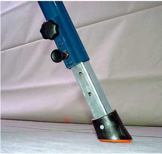
Die Höhenverstellbarkeit der Beine sowie die Funktionalität der Transportrollen müssen gegeben sein. Die Gerätefüße müssen über einen unbeschädigten Gleitschutz verfügen. Bei Nichtgebrauch der Geräte sind die Transportrollen in die Ruhestellung zu überführen.
