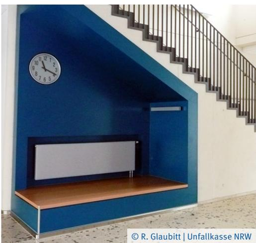
Die erforderliche nutzbare Breite der notwendigen Treppen darf durch offen stehende Türen, Einbauten oder Einrichtungen nicht eingengt werden.
