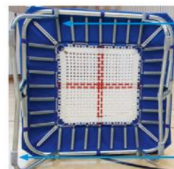
Abb. 11 Federzüge, Mittelstützen, Gleitschutz
