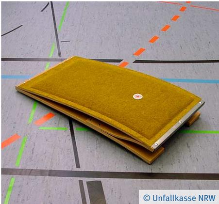
Sprungbretter dürfen sich bei Benutzung nicht verschieben, deshalb muss der Gleitschutz ausreichend und unbeschädigt sein. Hierdurch wird bei Benutzung eine ausreichende Haftung mit dem Hallenboden erreicht. Der Gleitschutz sollte keine Spuren auf dem Sportboden hinterlassen.
