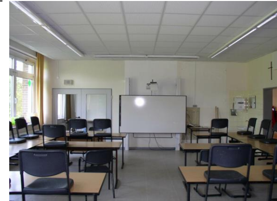
Abb. 3: Akustikdecke, geputzte Wände und Linoleum Fußboden; Foto: M. Buxtrup, UK NRW
